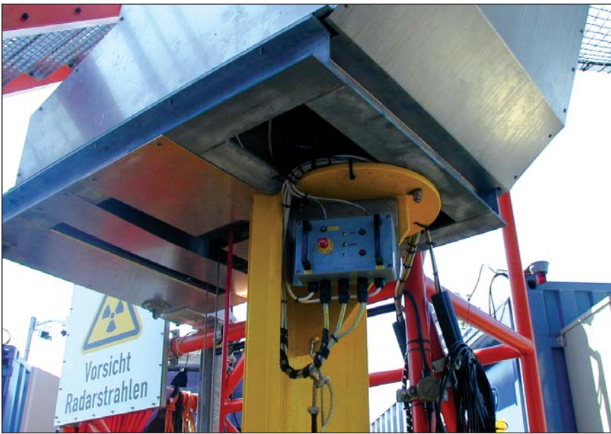
Die Unterseite des Lift - Windensystem (geparkt). Bilder Mitte und Unten : Die Unterwasserkamera in der Montage. Die erste Liftfahrt am Jacket.
